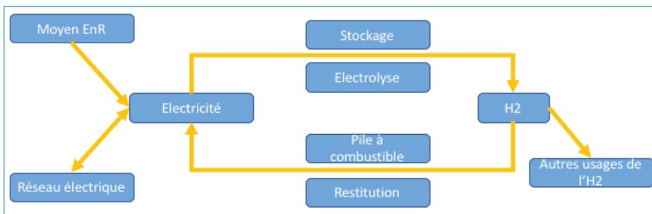
Lorsque l'installation est mise en œuvre en site isolé (comme dans le cirque de Mafate par exemple). Le couple électrolyseur/pile à combustible se révèle être très utile pour ajuster une production fatale d'électricité aux variations de la demande électrique. L'exploitant fera un arbitrage technico-économique entre d'autres éventuels usages de l'hydrogène et la génération d'électricité en retour via la pile à combustible.
